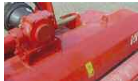
Esempio di protezione superiore in lamiera
