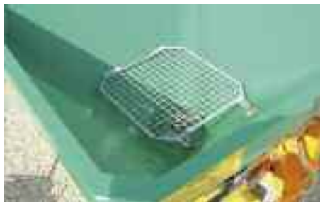
Griglia mobile nella tramoggia
