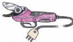
2. Mantiene in ordine **l'attrezzatura** che pulisce e lubrifica ogni giorno, affila le lame quando il taglio richiede più sforzo del normale, regola il gioco lama-controlama quando il taglio non è più netto.
