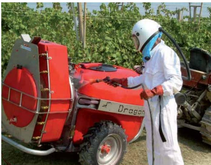
Una non corretta pulizia delle parti interne della macchina irroratrice (serbatoio, circuito idraulico, ecc.) e, soprattutto, una non adeguata gestione delle acque di lavaggio determina inquinamento oltre a danni ai componenti della macchina, intasamento degli ugelli e altri malfunzionamenti.
